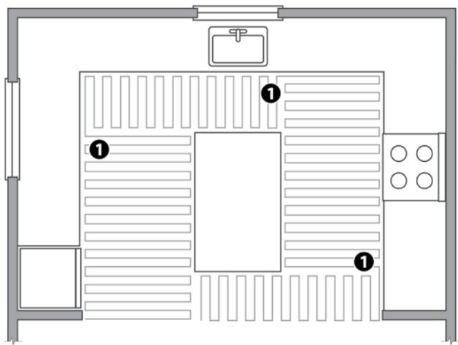
1. Changer de direction pour pouvoir installer le câble à l'espacement minimum requis des murs et objets fixes.
