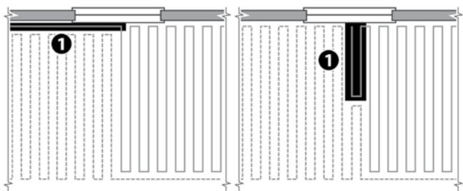
1. Terminar la instalación del primer cable cerca de una pared para que el segundo cable se imbrique adecuadamente.
