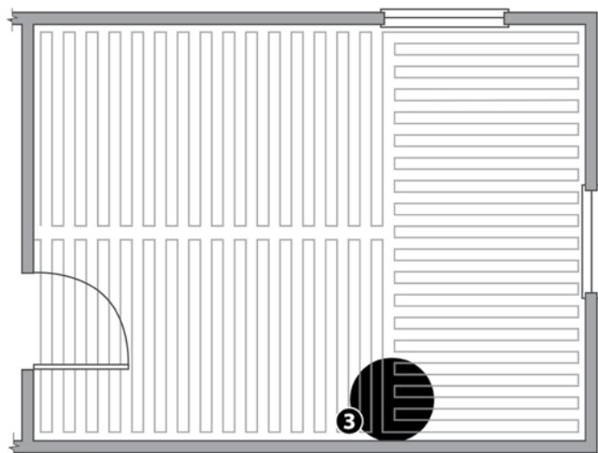
3. Cambiar de dirección si se necesita más flexibilidad cerca de una pared.
