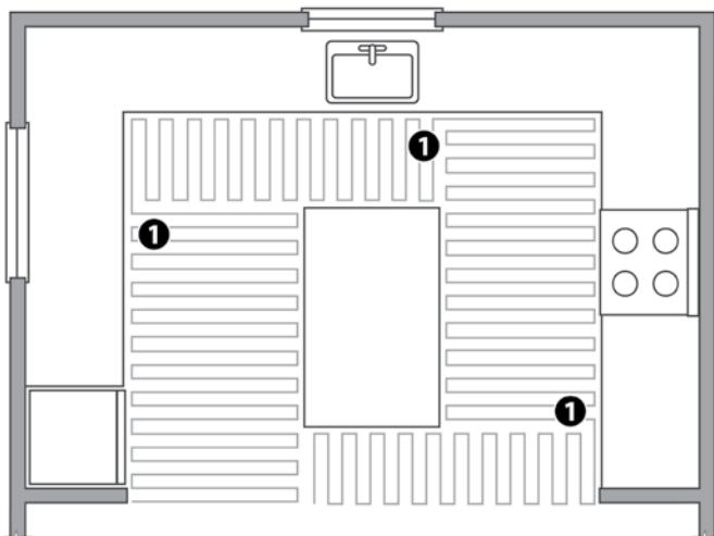
1. Cambiar de dirección para poder instalar el cable a la distancia mínima requerida.
